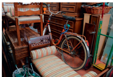
Dépôt de meubles: dès 1'000 MJ/m 2
