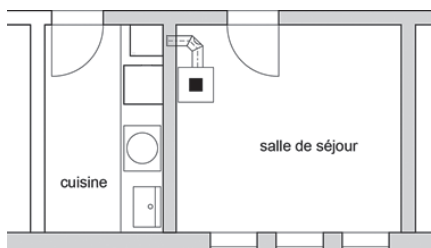
Cas 2: Illustration d'un chauffage à combustible solide, implanté librement dans un local occupé en permanence, dans une maison ou un appartement.
