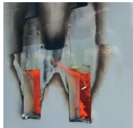
Exemple avec un test d'une isolation thermique extérieure crépie
