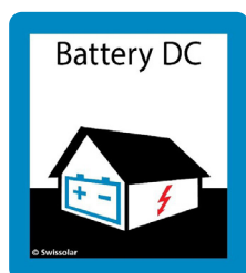
Signalétique selon Swissolar « Bâtiment avec uniquement batterie »
