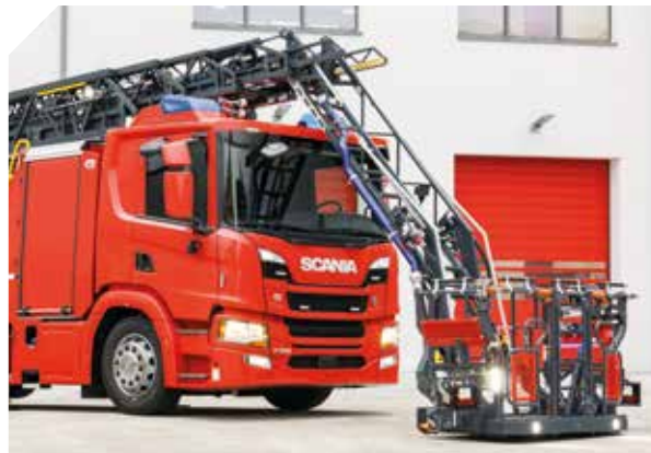
Plateforme avec prise en charge de patients sur brancard en plusieurs configurations possibles.
